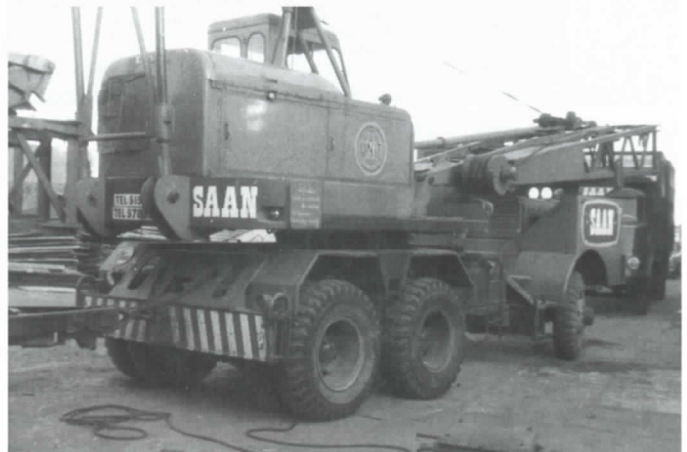
Een van de bijzondere voertuigen uit het uitgebreide wagenpark van de fa. Saan dat eind jaren '50, begin jaren '60 in gebruik was: een Unit opbouwkraan op een Avilable onderwagen
