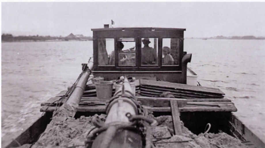
De oude zandschuit 'Cornelia Petronella' uit 1928. Het schip mat 25 m en had een laadvermogen van 72 ton c.q. 50 m 3 . In de stuurhut Cornelis Busker aan het stuurwiel met links zijn vrouw Truus. De foto werd in 1947 genomen vanaf de voorsteven van de boot (foto fam. Busker)
