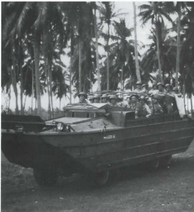
Voorafgaande aan de Eerste Politionele Actie van 1947 werd op de kust van Tjelingtjing van Java geoefend met een amfibisch voertuig, een zogenaamde GMC 'DUKW' (Duck).
