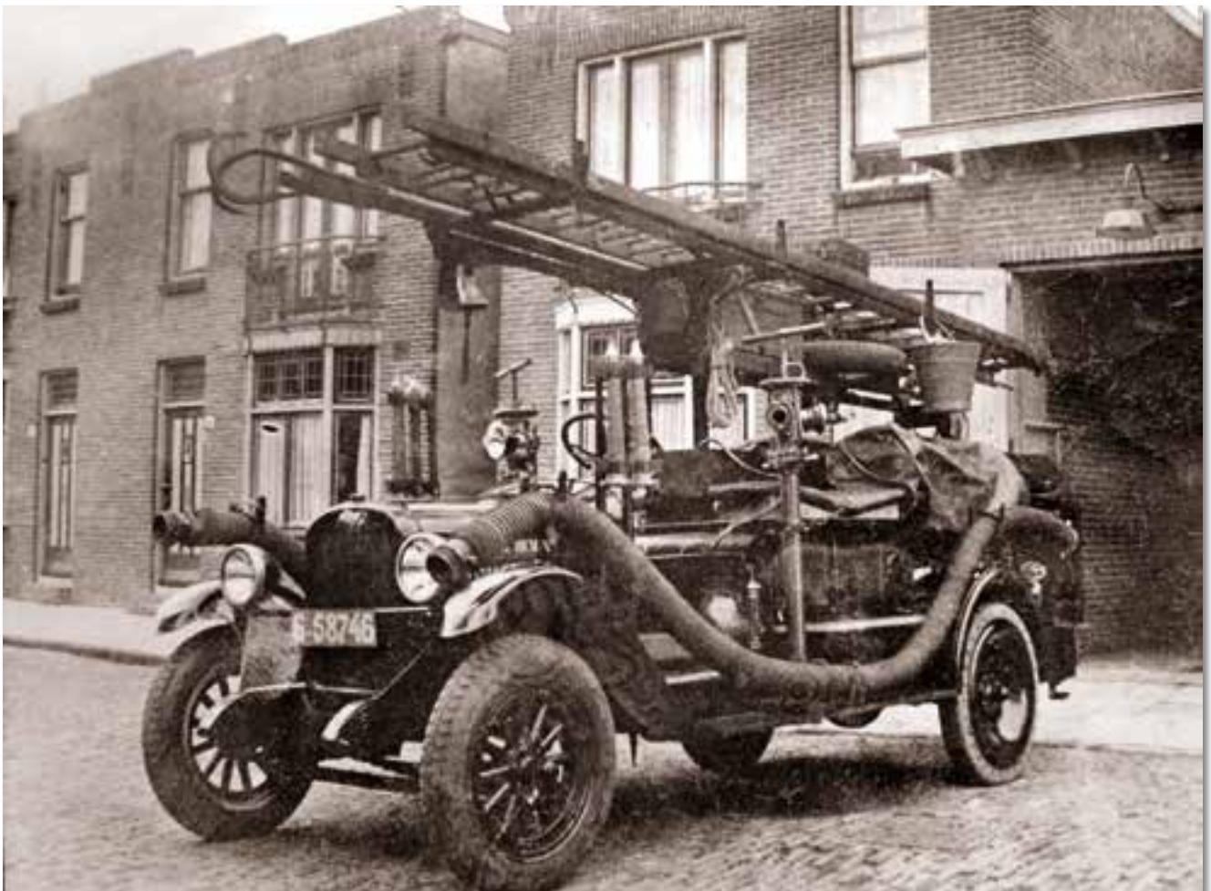
De Chevrolet motorbrandspuit met Bickers-opbouw voor de ingang van de garage aan de Raadhuisstraat medio 1928 (coll. HKD)
