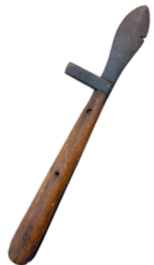
Het sigarenhamertje is heel oud, misschien wel al uit 1882. Met de platte bovenkant kun je een kistje sigaren openen zonder dit te beschadigen, met het gleufje het spijkertje eruit wippen. En met het hamertje voorzichtig dicht timmeren.
