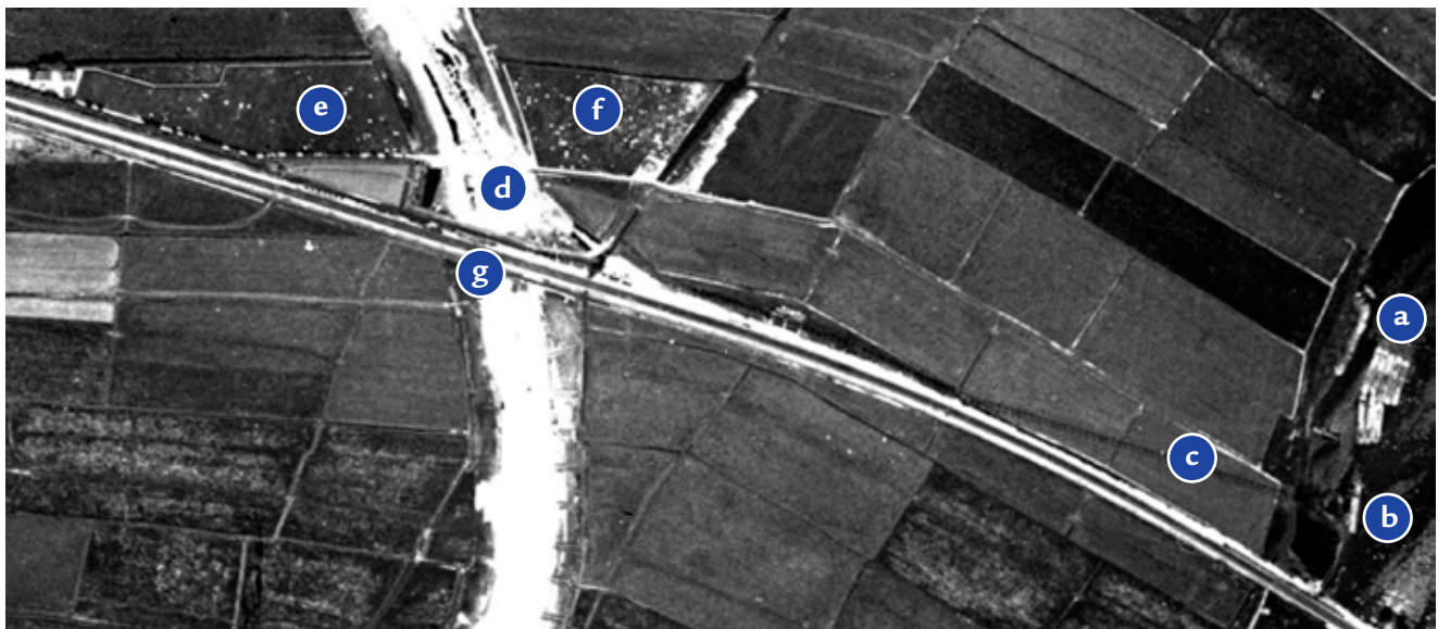
Detail van een luchtfoto uit 1937. Zichtbaar zijn de bakken met zand (a) en de bakkenzuiger in de Tweede Diem (b), de persleiding op houten jukken evenwijdig aan de Oosterspoorlijn (c) en het stort (d). Ook zijn het voorste (e) en het achterste veld (f) van de Ned. Isr. Begraafplaats te zien, verbonden door een grindweg in de vorm van U-constructie (g). (Universiteit van Utrecht)
